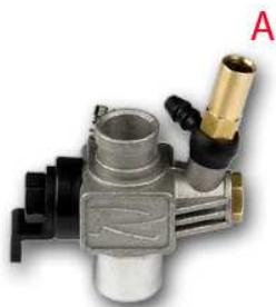
Fate girare in senso orario lo spillo del massimo fino a che non si arresta. Posizione completamente chiusa (non forzare altrimenti la punta dello spillo si potrebbe danneggiare) A. A questo punto svitatelo in senso anti-orario facendogli compiere 5 giri.
